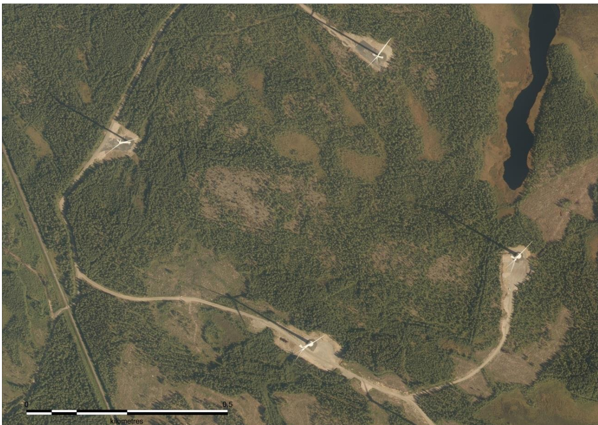
Kuva 2.7 Ilmakuvassa näkyy toiminnassa olevia tuulivoimaloita, huoltoteitä ja nostokentät. (MML, Ortoilmakuva)
