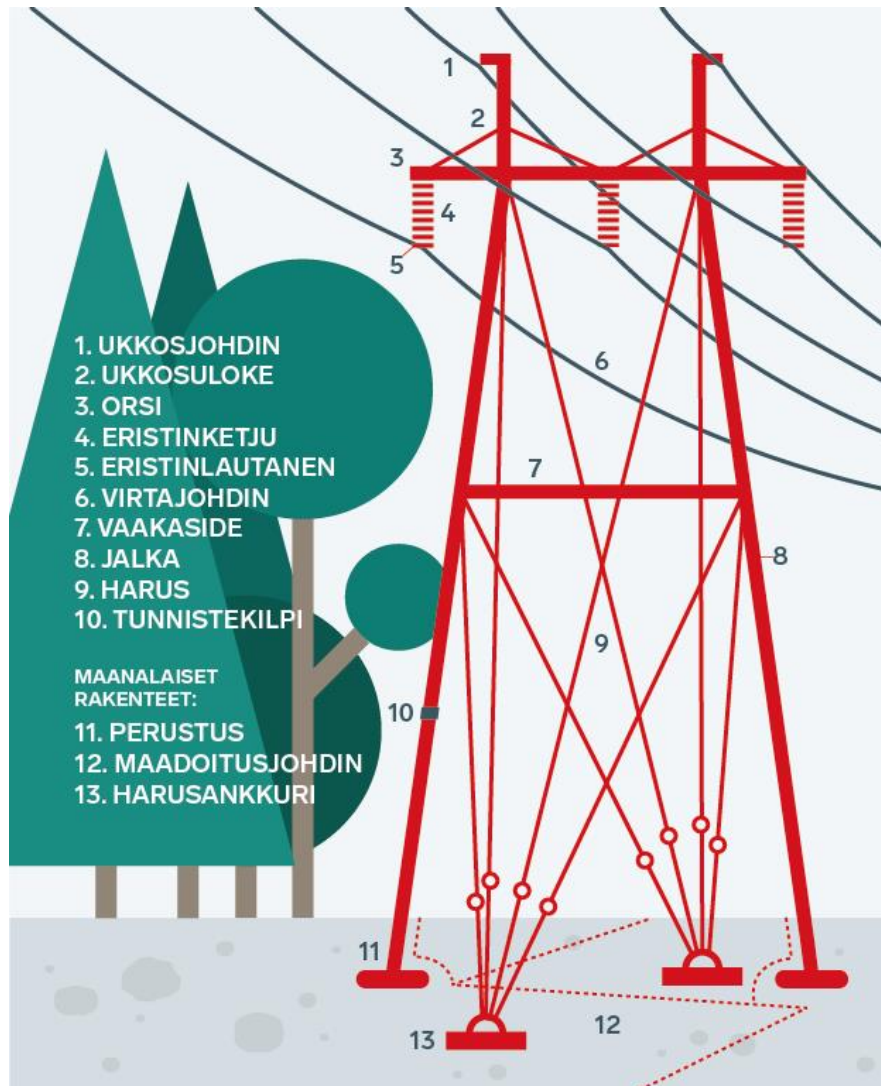
Kuva 6-4. Voimajohdon osat (Fingrid 2022).
